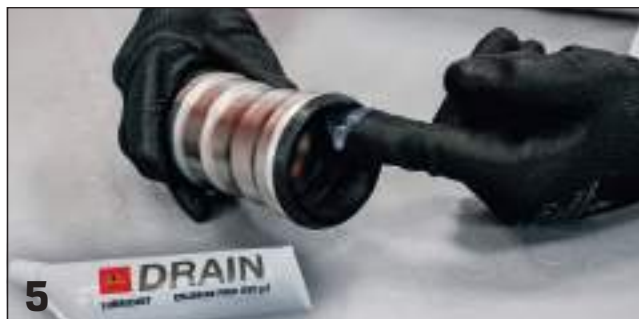
5 Lubrificazione zona interna guarnizione / Internal gasket lubrication
