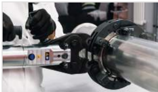
Assemblaggio pressatura n°1 / Press assembly phase 1
