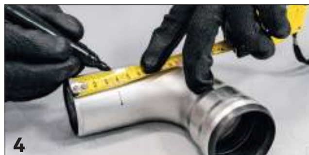
4 Marcatura quota d'innesto / Marking the insertion's depth
